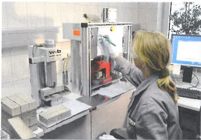
Рис. : 2–4: Центральная лаборатория компании HeidelbergCement AG в городе Эннигерло была оптимизирована для проведения испытаний большого количества образцов. Стандартные цементные растворы хранятся в специальных стальных емкостях. Результаты испытаний прочности при сжатии цементных растворов автоматически присваиваются образцу, зарегистрированному в системе лабораторной информации и управления (LIMS) центральной лаборатории и оцениваются статистически.
