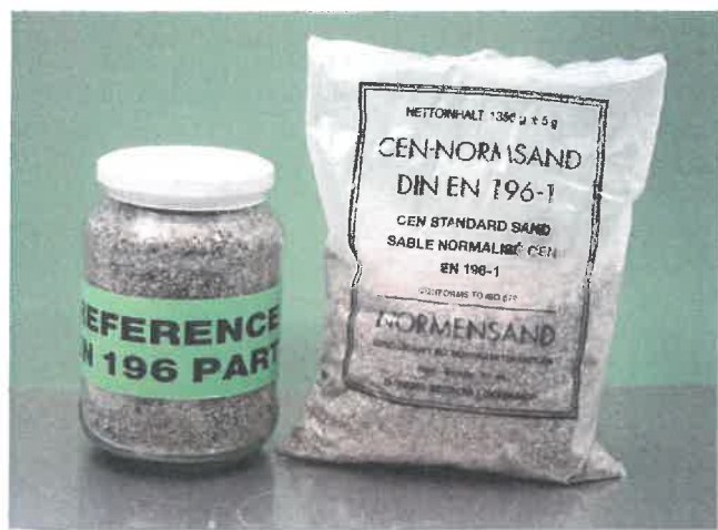
Рис. 1: В соответствии с EN 196-1, стандартный песок по CEN должен быть упакован в пакеты весом 1350 \pm 5 г. Три растворные балочки могут быть изготовлены из одного пакета. Специфицированный вес пакета минимизирует ошибки взвешивания в лаборатории. Эталонный песок по CEN, то есть фундаментальный стандарт для испытываемого песка, хранится и продается в стеклянных банках, упакованных компанией Normensand GmbH.
