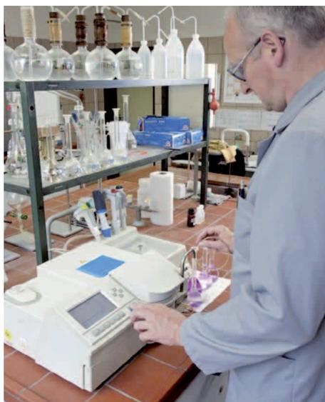
Bestimmung verschiedener chemischer Parameter mit dem Photometer Cadas 200 im nasschemischen Labor.
