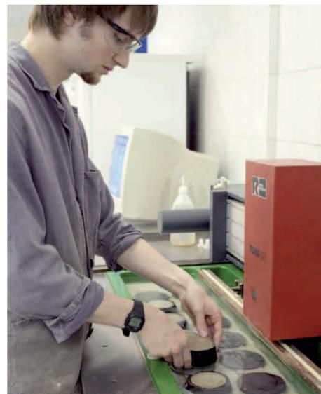
Bestimmung der Erstarrungszeiten im Wasserbad mit dem Nadelgerät nach Vicat gemäß DIN EN 196-3.
