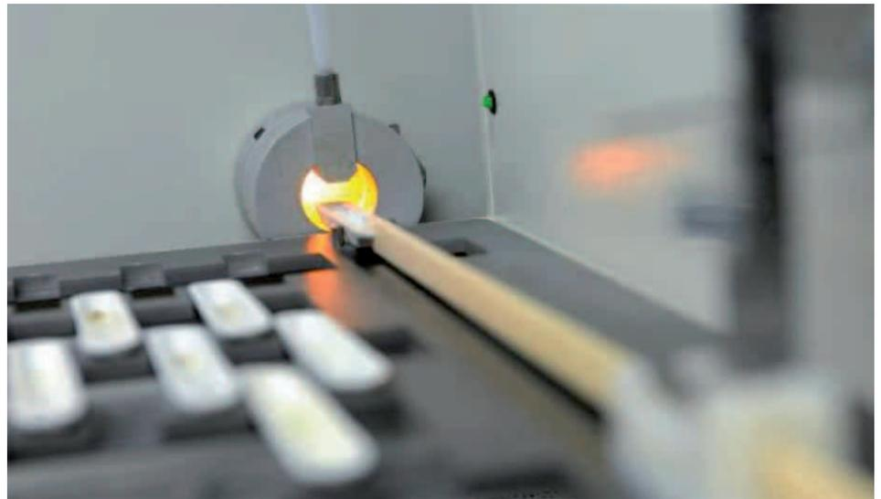
Überprüfung des  $\text{SO}_3$ -Gehalts im Zement mit dem Multi EA.
