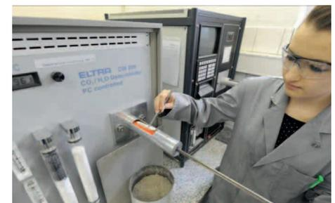
Bestimmung des  $\text{CO}_2$ -Gehalts und des Glühverlusts an einer Kalksteinprobe mit dem Eltra CW 800 im Zentrallabor Ennigerloh.
