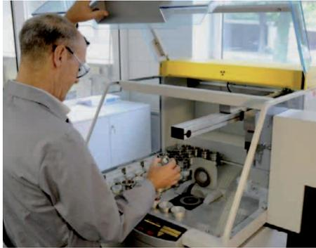
Das Röntgenlabor des Zentrallabors Ennigerloh besteht aus einem Röntgen-Diffraktometer (XRD) sowie einem Röntgen-Fluoreszenz (RF)-Gerät. Mit dem Axios Cement (RF) werden unter anderem die Klinkerproben analysiert. Das Gerät ist an das automatische Probenahmesystem des Werkes angeschlossen. So werden beispielsweise die chemischen Zusammensetzungen von Rohmehlproben bzw. Zementproben ½-stündlich bzw. stündlich bestimmt.
