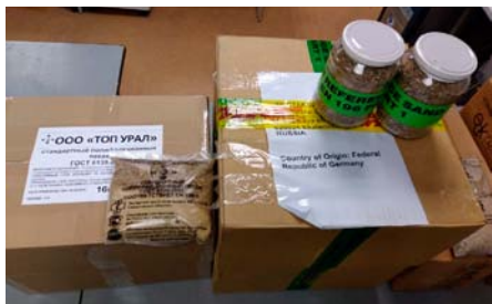
Стандартный полифракционный песок ГОСТ 6239—2020 от ООО «ТОП УРАЛ» и эталонный полифракционный песок от Normensand GmbH
