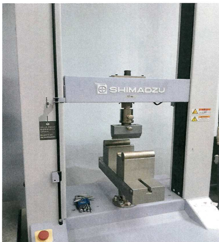
Рисунок 2 - Универсальная испытательная машина AGS-10 kNX, зав. № I33065534571
