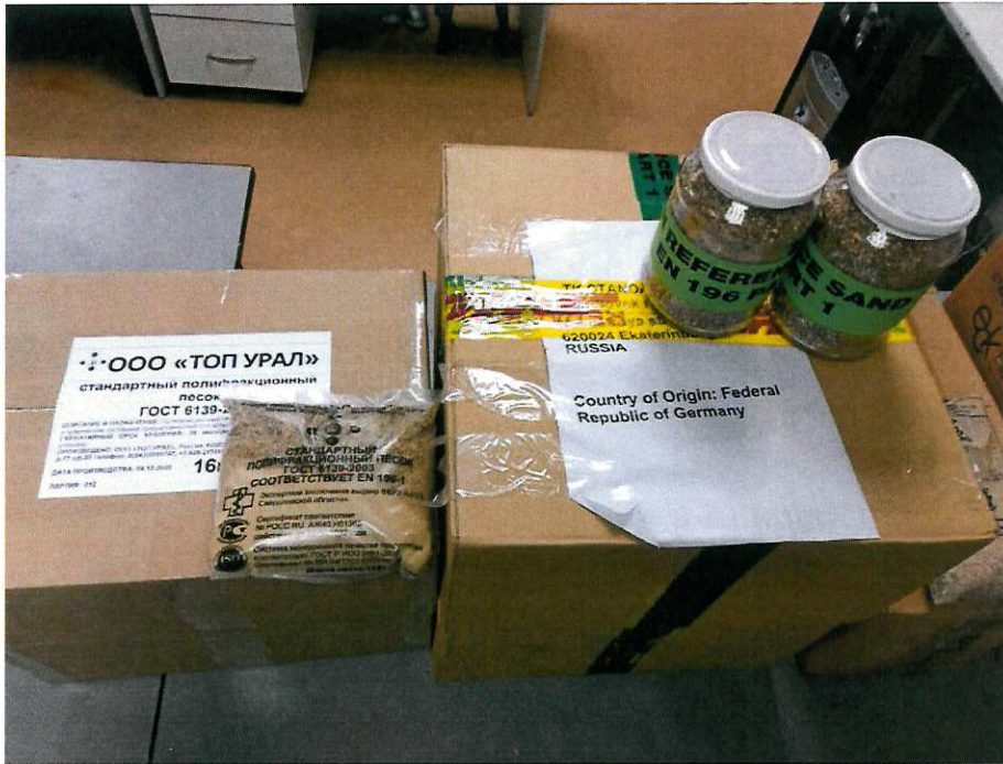
Рисунок 5 - Стандартный полифракционный песок ГОСТ 6139 ООО «ТОП «УРАЛ» и эталонный полифракционный песок «CEN REFERENCE SAND EN 196 PART 1» NORMENSAND GMBH, Deutschland
