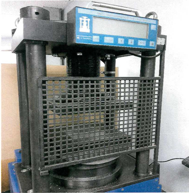
Рисунок 3 - Пресс испытательный гидравлический малогабаритный ПГМ-1000МГ4, зав. № 58
