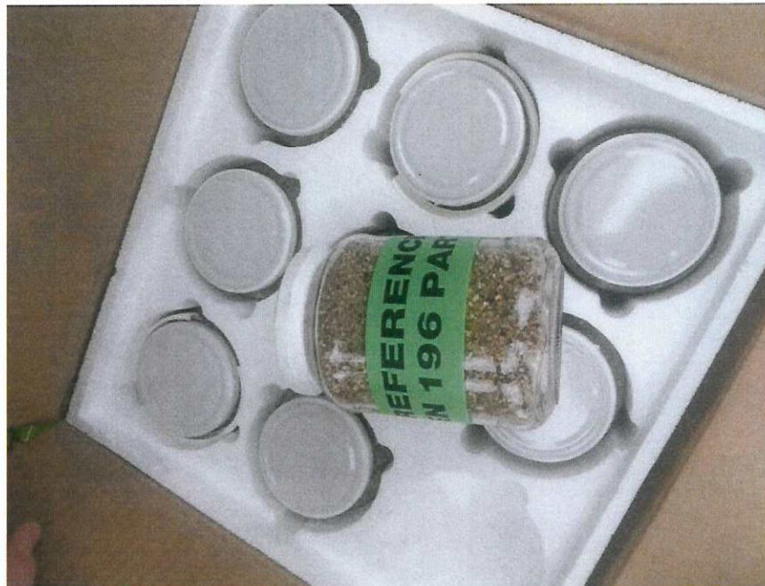
Рисунок 4 - Эталонный полифракционный песок «CEN REFERENCE SAND EN 196 PART 1» NORMENSAND GMBH, Deutschland
