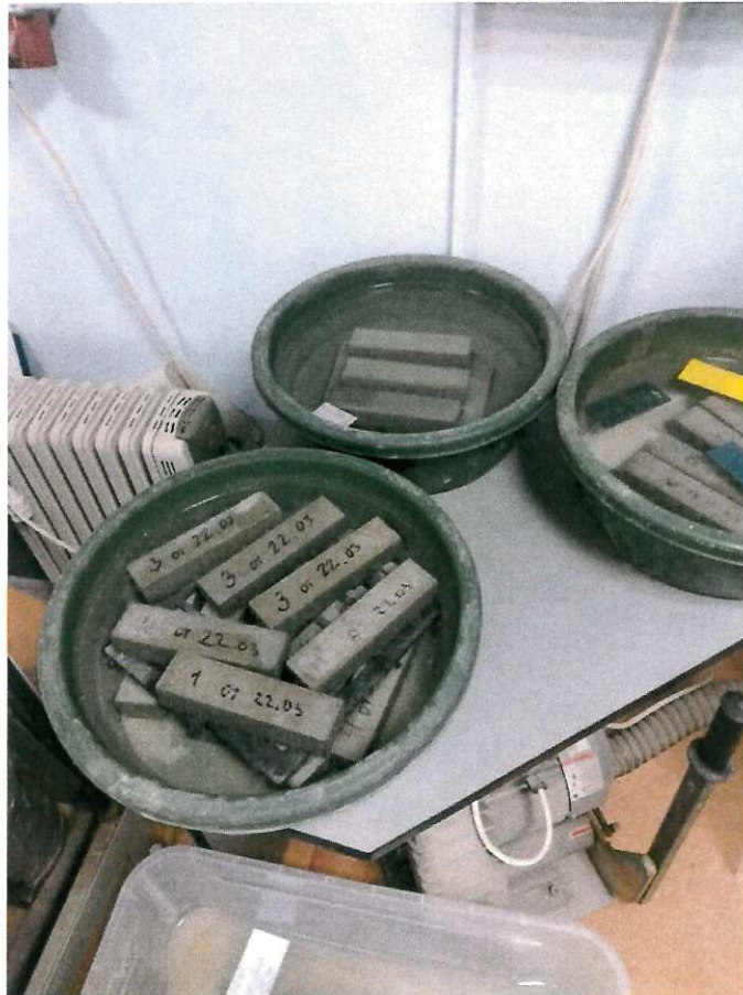
Рисунок 6 — Хранение образцов-балочек в воде по ГОСТ 30744
