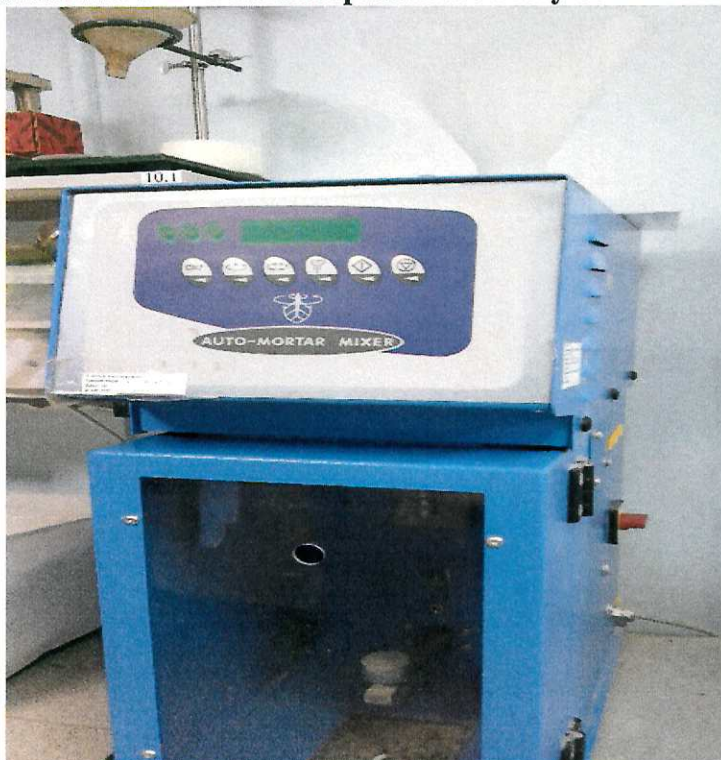
Рисунок 1 - Автоматический растворосмеситель E093, зав. № E093/AE/0017
